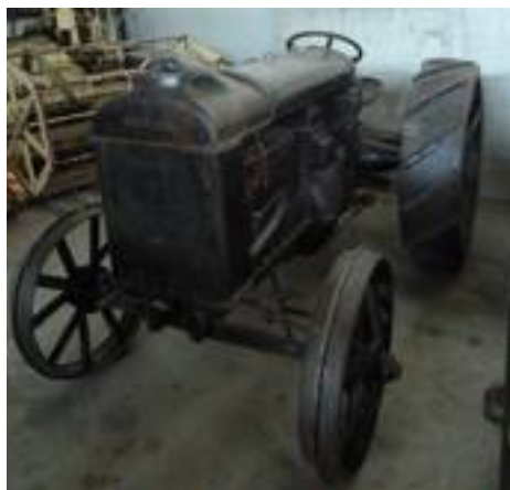
■ Fordson modello F con motore a petrolio degli anni Venti.
