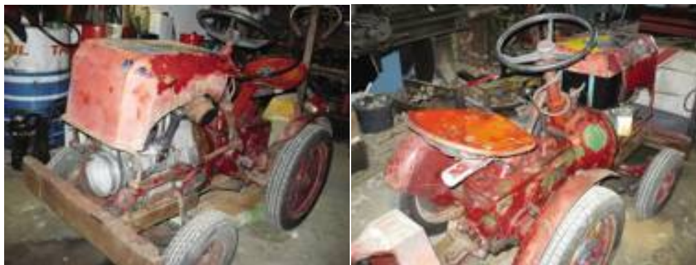
■ Il Lugli Junior era un trattorino usato per la movimentazione dei carichi nelle fornaci. Questo esemplare, che necessita di notevoli cure, è uno dei pochi rimasti dopo la demolizione di massa conseguente alle nuove norme in materia di sicurezza sul lavoro.
