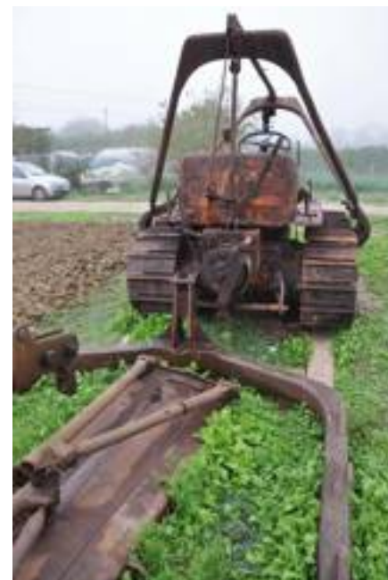
■ Il Fiat 52 visto da dietro. In basso si notano arco e lama apripista.
