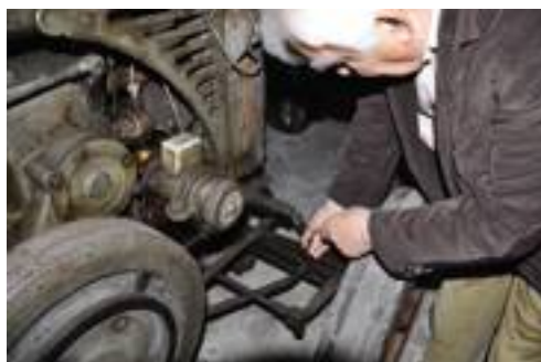
■ Il deviatore che, nel Landini L25, convogliava i gas di scarico al sollevatore.
