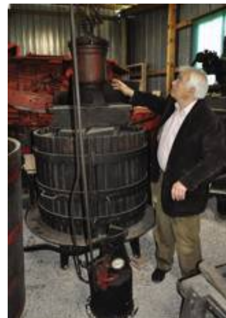
■ Il torchio azionato con una pompa idraulica.
