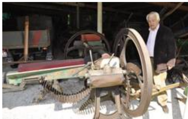
■ Il trinciaforaggio a 4 tagliole, costruito in Romagna, a Gatteo.
