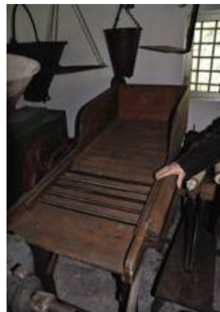
■ L'attrezzo per pulire, tramite 5 rulli con scabrosità, i bozzoli dei bachi da seta.
