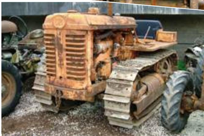
■ Il cingolato OM 35-40, marciante, ma da restaurare, e particolari della strumentazione originale.
