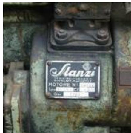
■ Il musetto, la strumentazione e la targhetta di alluminio con il numero di identificazione del motore dello Slanzi Amico SD53.
