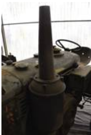
■ Marmitta da strada (a sinistra) e marmitta tradizionale, sempre per i modelli Landini testa calda.
