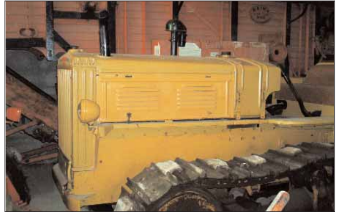
Trattrice Ansaldo Fossati TCA70. Si può notare lo "scafo" impenetrabile che lateralmente arriva fino a metà motore.
