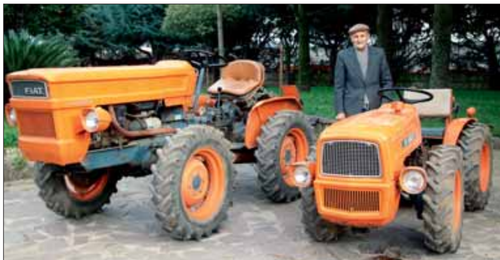
A sinistra: Fiat 250M/1, penultima versione “da montagna” della piccola , prodotta dalla ditta Fratelli Calzolari. A destra: Fiat 220, versione snodata della piccola , prodotta dalla ditta Silms e caratterizzata da un ridottissimo ingombro, come testimonia Vincenzo De Biase, padre del collezionista.
