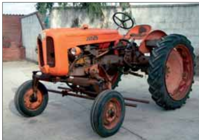
Fiat 211Rb factotum , versione speciale destinata per lo più al mercato australiano. Montava pneumatici 9X36 e fuselli prolungati per scavalcare più agevolmente le colture.
