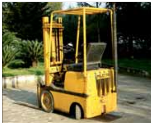
La ditta Miletto di Torino utilizzò la meccanica della piccola (motore e trasmissione) per realizzare piccoli muletti industriali.
