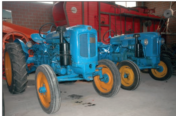
Landini R25 e Landinetta: i primi Landini con motore Diesel ad avviamento veloce e colore azzurro.
