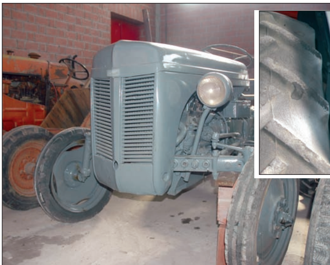
Massey Ferguson con avviamento elettrico, sollevatore e presa di forza. Il trattore smette di essere semplice mezzo di traino e si avvicina agli standard moderni.
