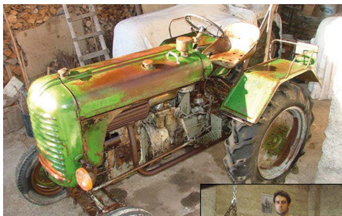
■ Lo Steyr 182 di Gamba presenta un dispositivo originale a richiesta per l'epoca: il compressore volumetrico con serbatoio. Nel riquadro, fase di smontaggio del motore del 182.
