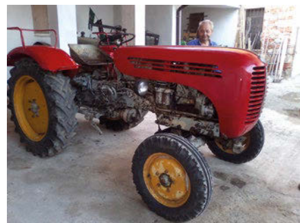
■ Questo 188 è del primo anno di produzione: per l'avviamento a freddo invece della candele elettrica, dispone del thermostart , un dispositivo che incendia una piccola quantità di combustibile nel collettore di aspirazione. Dietro il trattore si intravede il nonno Carlino Viviani.
