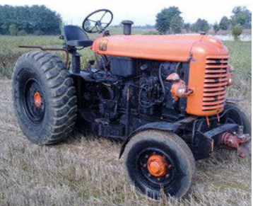
■ Steyr 280a industriale, modificato specificatamente per il traino di pesanti rimorchi presso il porto marittimo di Genova, verso la fine degli anni Sessanta. A destra si trova assieme al 280 normale, diffuso in meno di 1.000 esemplari probabilmente a causa del prezzo di acquisto.
