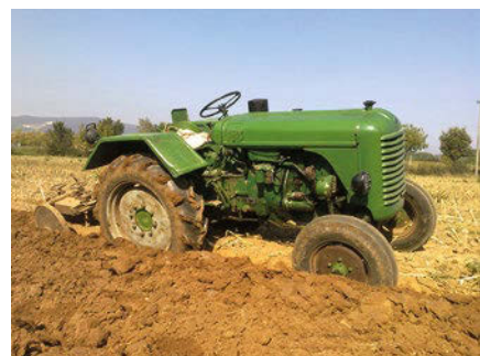
■ Nell'N182a il cambio presenta 4 marce agricole e 4 marce stradali, oltre a 4 velocità per la retromarcia.
