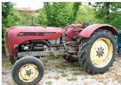
■ Steyr 288, quattro cilindri e 45 cavalli di potenza.
