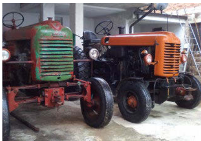
■ Steyr 280a industriale, modificato specificatamente per il traino di pesanti rimorchi presso il porto marittimo di Genova, verso la fine degli anni Sessanta. A destra si trova assieme al 280 normale, diffuso in meno di 1.000 esemplari probabilmente a causa del prezzo di acquisto.
