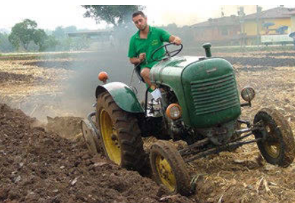
■ Il tipo 180 esportazione Italia si differenzia dal 180 originale, che era carenato integralmente ed aveva il filtro dell'aria a secco, disposto internamente al serbatoio del carburante.
