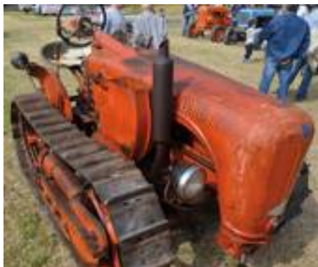
■ L'Oto 25 può sostituire i cingoli con il kit di 4 ruote.
