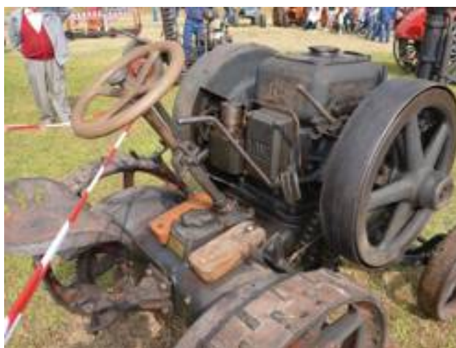
■ Questo Lanz è considerato il primo vero trattore (1921). Come si può notare dalla foto a destra, gli aggrappi dei cerchi in ferro sono totalmente consumati.
