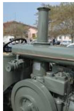
■ Superlandini: presa d'aria alta per evitare la polvere.
