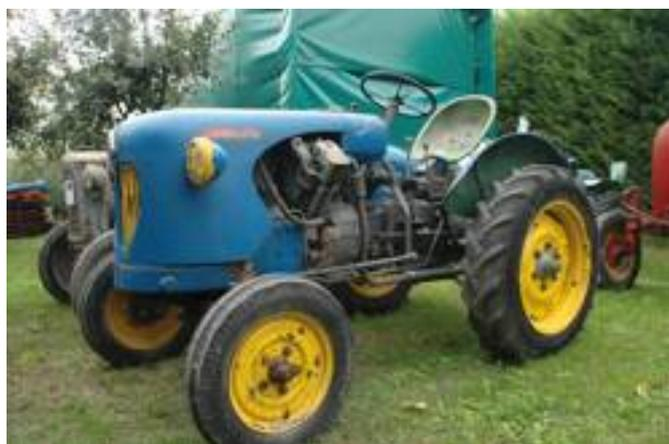
■ Lombardini bicilindrico con motore a V: una delle tante stranezze della storia della meccanizzazione agricola.
