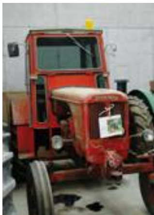
■ Schluter As 45, all'epoca portabandiera della casa tedesca, con motore da 4,8 litri per 45 cavalli di potenza.
