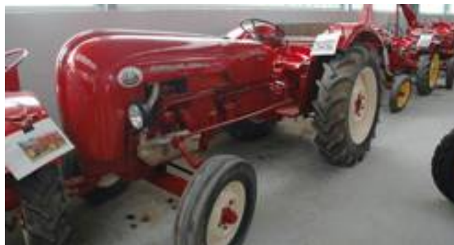
■ Porsche Diesel Standard, realizzato a partire dall'Allgeier- Porsche 122, con motore bicilindrico da 1,6 litri e 25 cavalli di potenza.
