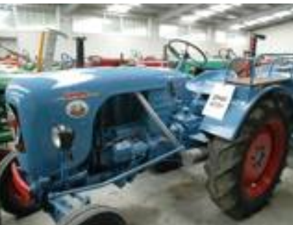
■ Eicher L28: sul mercato dal 1950 al 1957, monta un motore Deutz da 2.600 cc per 28 cavalli di potenza e trasmissione ZF.
