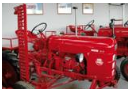
■ Il D 17 era un trattore con motore bicilindrico e 17 cavalli di potenza, spesso equipaggiato con barra falciante.
