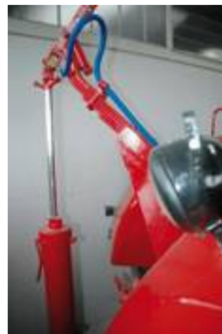
■ L'originale sistema di sollevamento posteriore di un Fahr D 60L.
