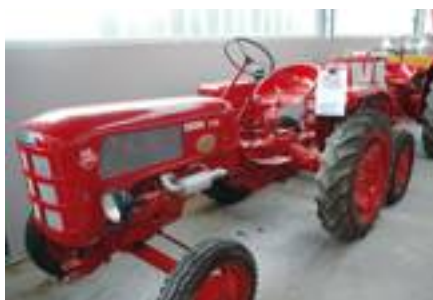
■ Fahr D88, risalente alla seconda metà degli anni cinquanta, con motore diesel bicilindrico da 885 cc Guldner, per 15 cavalli di potenza.
