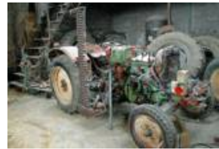
■ Uno degli interventi più difficili degli ultimi anni è stato smontare la testata di uno Schluter fermo da decenni ed esposto alle intemperie.
