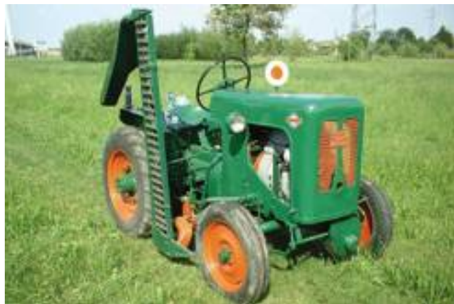
■ Carioca Bonacini e Chiossi con motore Tebaldini da 9 CV a petrolio del 1953, il primo "trattore" comprato dall'azienda Santachiara.
