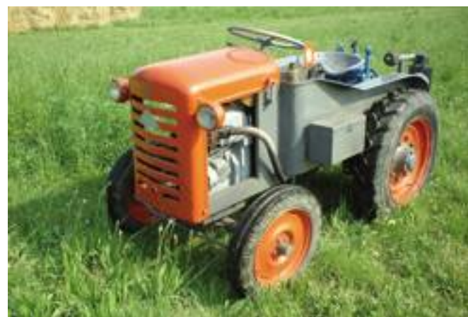
■ Prandi & Scaravelli, carioca del Reggiano, con motore Co.Ti.Emme da 7 CV a petrolio del 1953.
