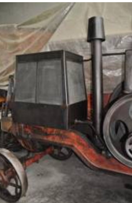
■ Il sistema di raffreddamento 'a pioggia' dell'acqua della locomobile.
