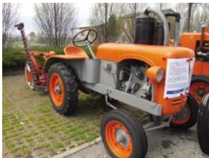
■ Una delle prime carioche alimentata con gasogeno, trainante una macchina da segare costruita dalla ditta Officine Reggiane di Reggio Emilia.
