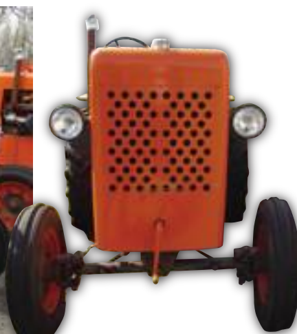
■ Cariocha fabbricata con il materiale degli autocarri militari Fiat SPA 38 e SPA Dovunque.
