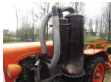
■ Particolare del gasogeno a legna e della fucina per la ventilazione al suo interno.
