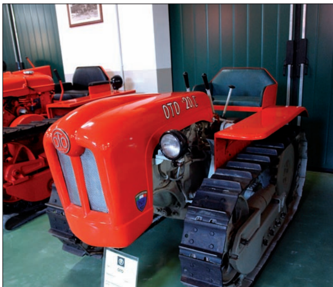
Il '20C cingolato non entrò mai in produzione, perché ritenuto troppo pericoloso: si ribaltava facilmente dietro e lateralmente perché troppo corto.
