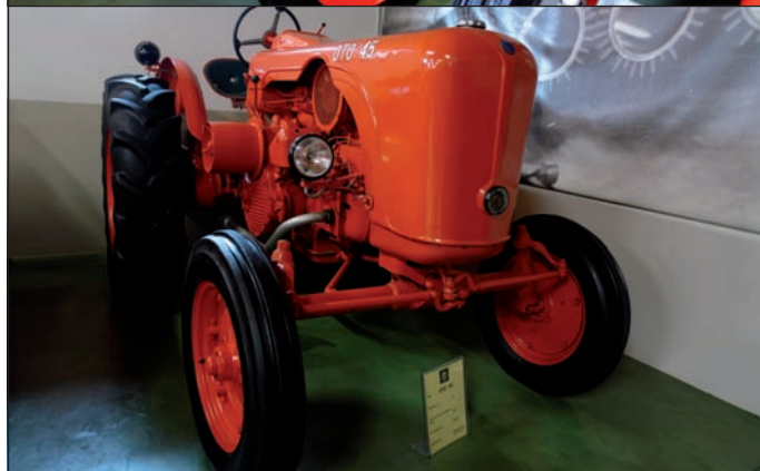
L'Oto C40 e '45' furono gli unici due Oto Melara bicilindrici e avevano tre prese di forza (contro le due dei precedenti).
