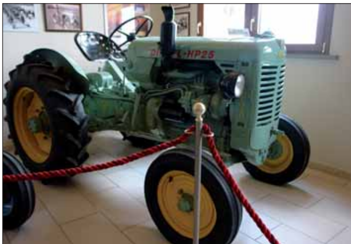
Il SuperTitano 25 aveva motore a 3 cilindri verticali e raffreddamento ad acqua.
